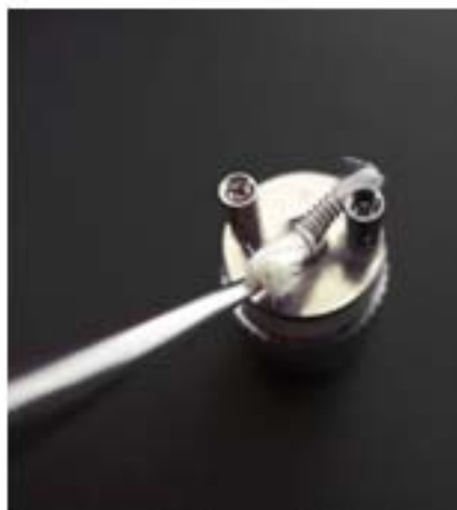
Untere Teil, Heizspirale immer entgegengesetzt der Halterung einfädeln, somit ist der Genaue Sitz über dem Lüftungsloch gewährleistet.
